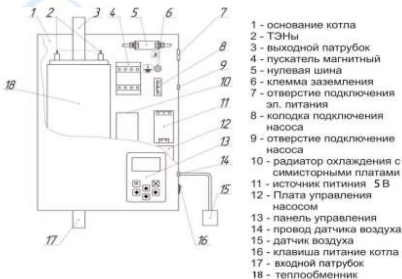
Рисунок 1. Устройство отопителя РЭКО серии П
