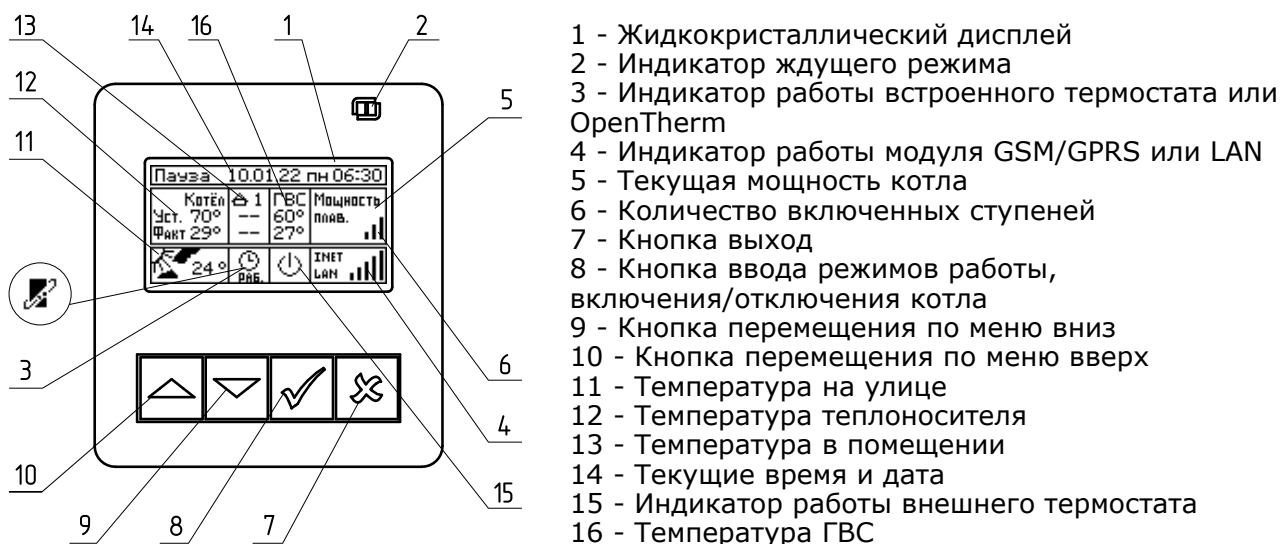
Рис.3. Расположение органов управления и индикации на передней панели
