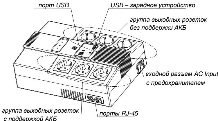
Рисунок 1 – Общий вид и элементы подключения
