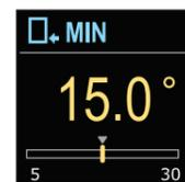
С помощью кнопок ⊖ и ⊕ вы можете установить нижний предел требуемой температуры в режиме охлаждения. Подтвердите установку с помощью кнопки ⊙. Если вы случайно выбрали неправильный нижний предел, вы можете вернуться к выбору нижнего предела с помощью кнопки ⊙.
