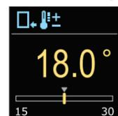
С помощью кнопок ⊖ и ⊕ вы можете установить требуемую температуру в режиме охлаждения. Подтвердите установку с помощью кнопки ⊙. Если вы случайно выбрали неправильную требуемую температуру, вы можете вернуться к выбору требуемой температуры с помощью кнопки ⊙.
