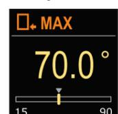
С помощью кнопок ⊖ и ⊕ вы можете определить верхний предел требуемой температуры в режиме обогрева. Подтвердите установку с помощью кнопки ⊙. Если вы случайно выбрали неправильный верхний предел, вы можете вернуться к выбору верхнего предела с помощью кнопки ⊙.
