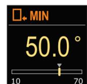
С помощью кнопок ⊖ и ⊕ вы можете определить нижний предел требуемой температуры в режиме обогрева. Подтвердите установку с помощью кнопки ⊙. Если вы случайно выбрали неправильный нижний предел, вы можете вернуться к выбору нижнего предела с помощью кнопки ⊙.
