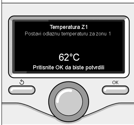
Izmena temperature tople vode za grejanje
