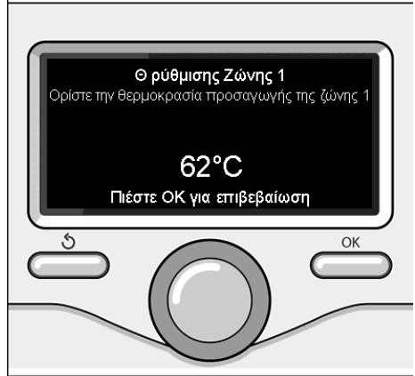
Τροποποίηση θερμοκρασίας ζεστού νερού θέρμανσης
