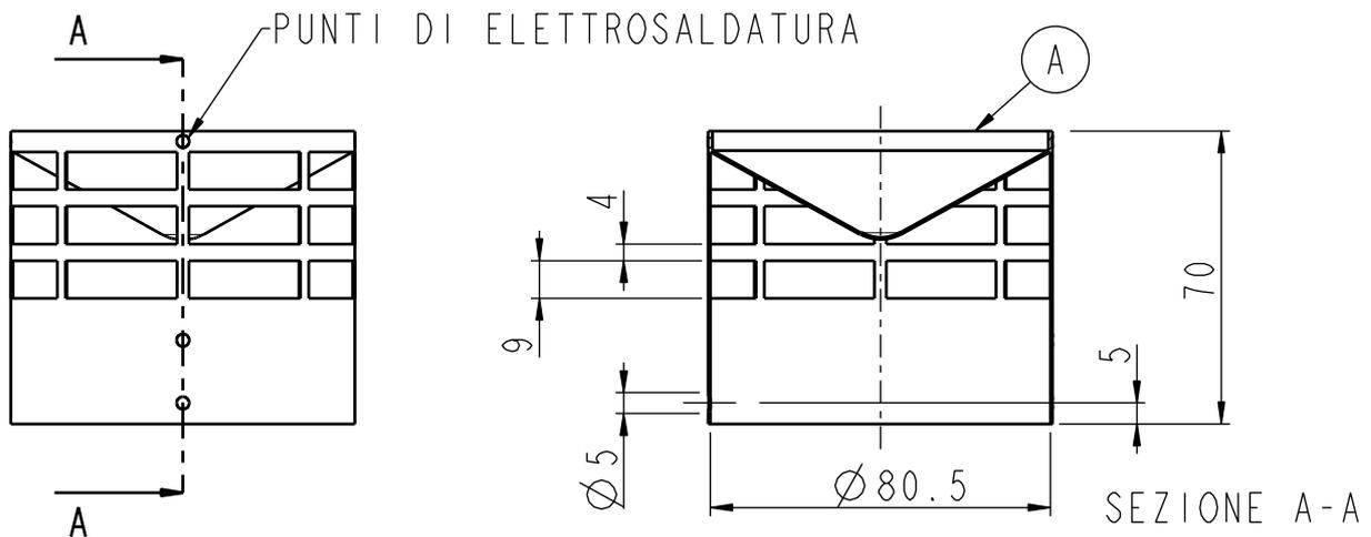
N.B: LA FASCIA E IL CONO SONO FISSATI CON ALMENO 6 PUNTI DI ELETTRISALDATURA.
