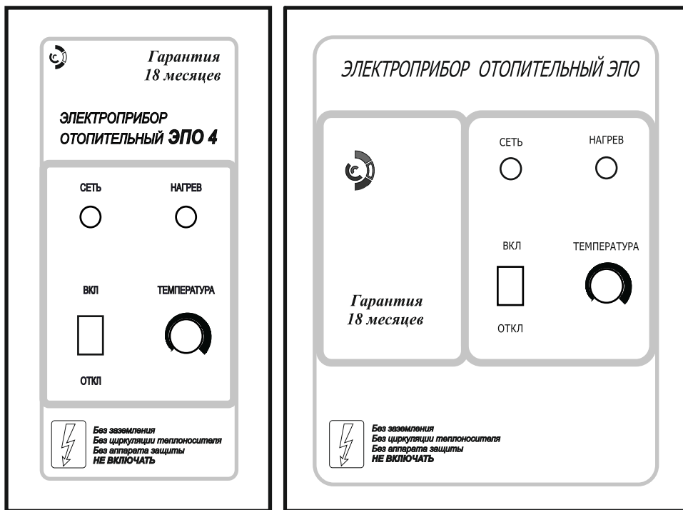
Рисунок 3. Пульты управления ПУ ЭПО-М1-4 и ПУ ЭПО-М1-6-30
