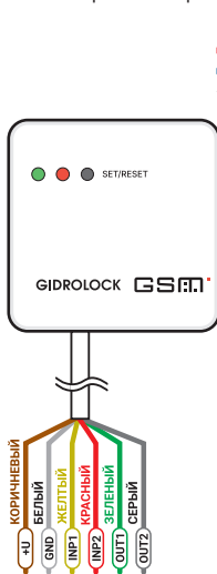
Рис. 2. Цвета проводов GSM-модема GIDROLOCK и их функциональное назначение
