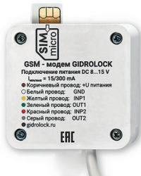
Фото 2. Установка SIM-карты в GSM-модем
