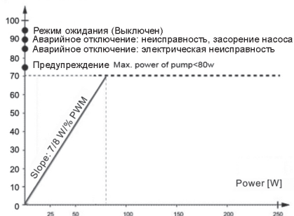
Рис 8. Логика сигнала обратной связи ШИМ
